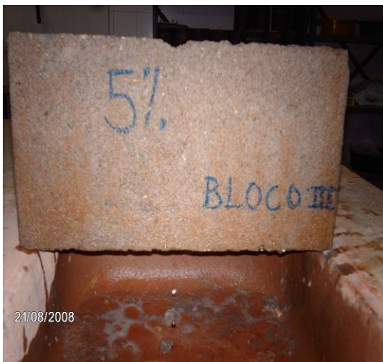
Figura 32 – Retirada do Excesso de Água
