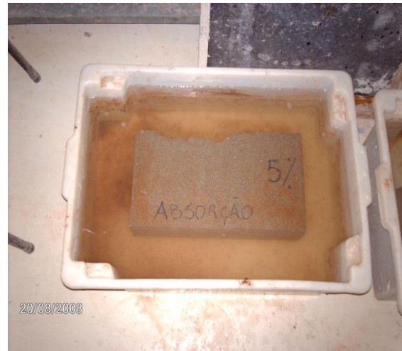
Figura 31 –Imersão em Água – 24Hs Massa Saturada (M2)
