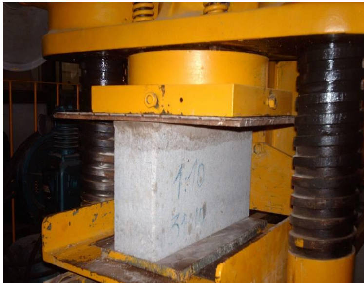
Figura 22 – Ruptura dos Blocos
