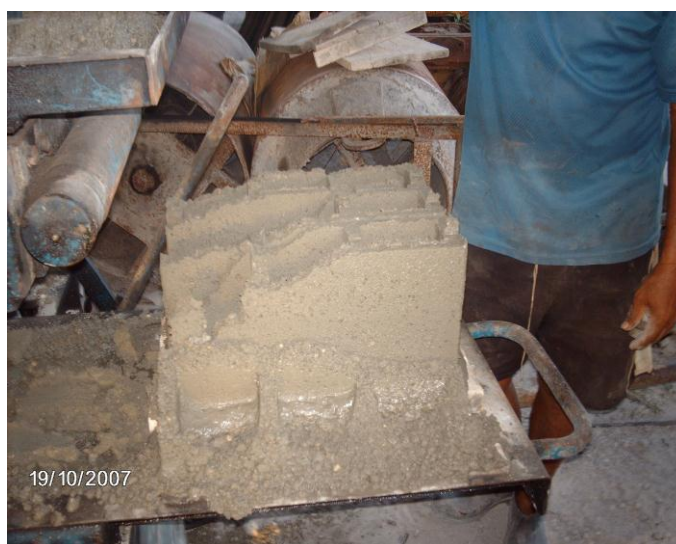
Figura 18 – Quebra Após Compactação.
