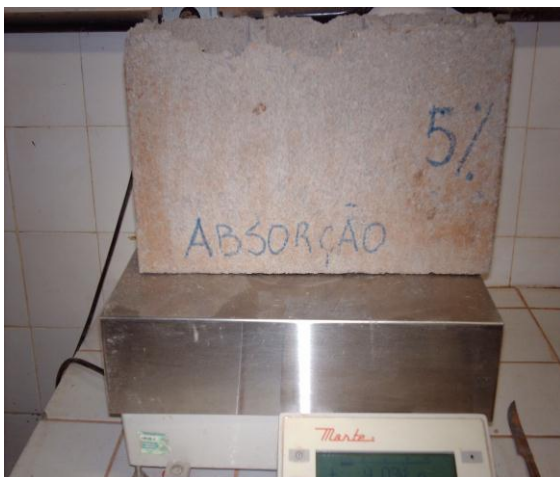
Figura 28– Pesagem do Bloco – M3
