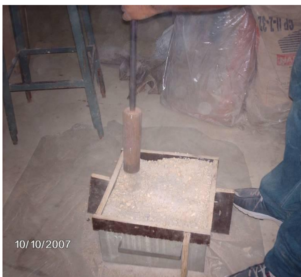
Figura 09 – Adensamento do Material.
